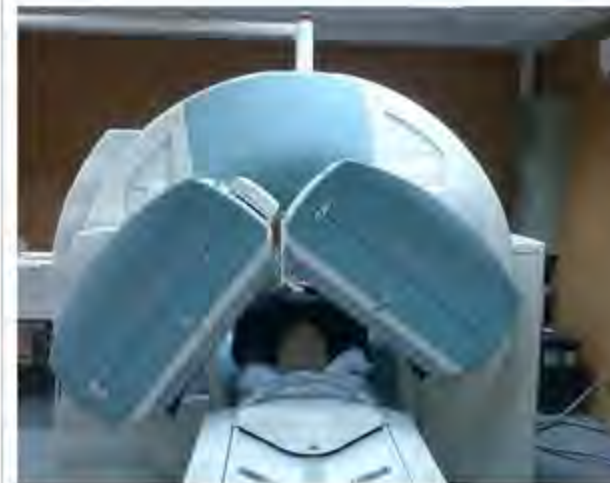
Fig. 1. Photographie de la gamma-caméra hybride Symbia T6 avec les deux détecteurs configurés en 90°
